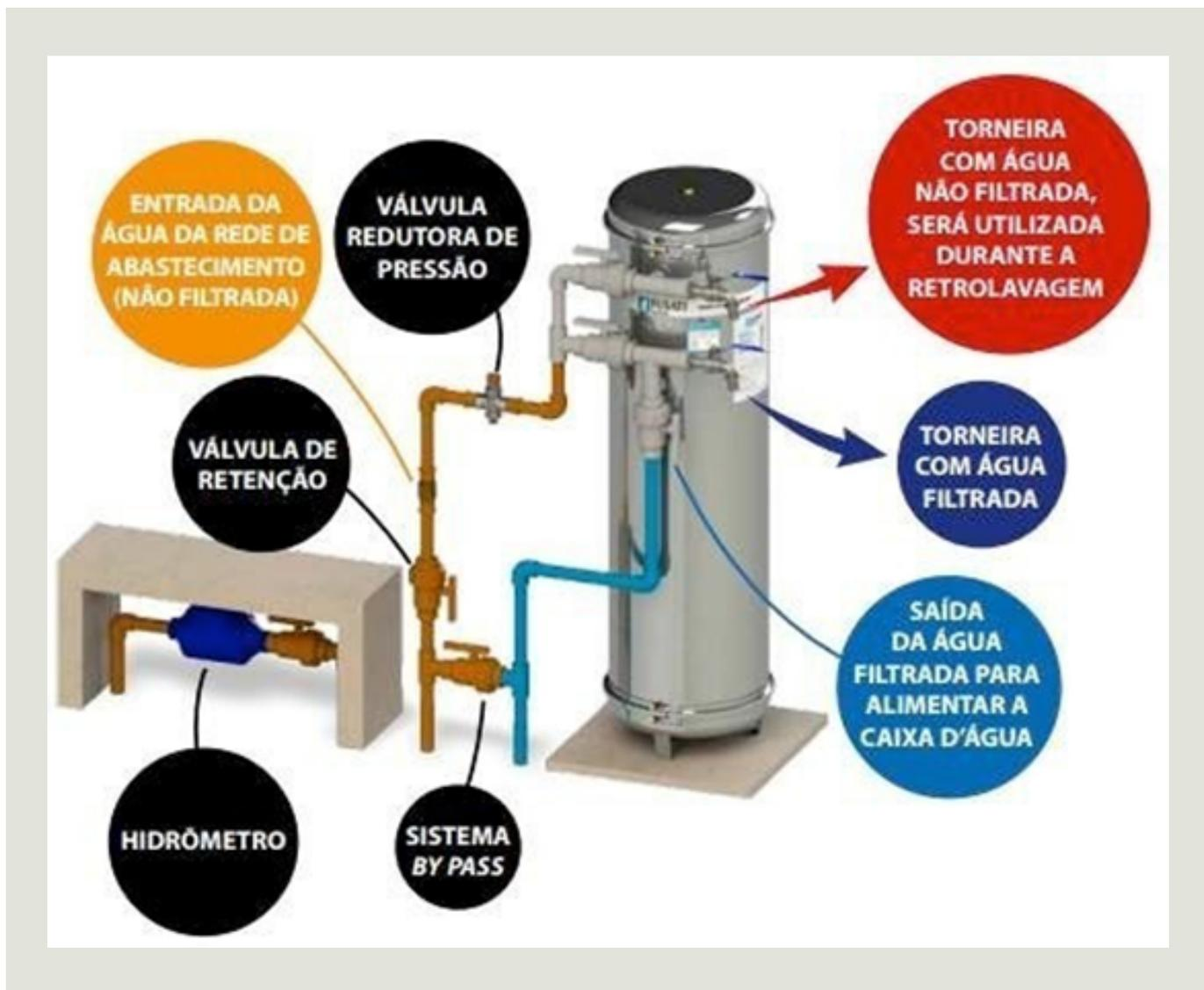
Sistema de filtragem para residências, condomínios e indústrias, provenientes de abastecimentos por concessionárias ou por sistemas alternativos: poços, cisternas, captação de águas superficiais e subterrâneas.
